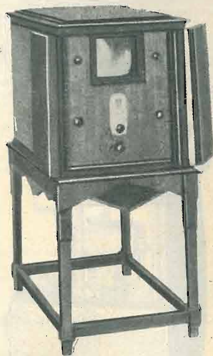
Fig. 4. — Uno degli ultimi più perfezionati apparecchi di televisione commerciale, della compagnia Baird americana. L'apparecchio possiede 1 AF schermata, rivelatrice senza reazione e 2 BF a resistenza con 245 finale. Onde corte.
